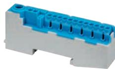
Klemme, für starre Leiter, 15 Klemmstellen, 1x schraubbare Klemmstelle 25 mm<sup>2</sup> (1,5-25 mm<sup>2</sup> re, 1-16 mm<sup>2</sup> rf+AD) , 2x schraubenlose Klemmstelle 4 mm<sup>2</sup> (1-4 mm<sup>2</sup> re, 1-2,5 mm<sup>2</sup> rf+AD), 12x schraubenlose Klemmstellen 2,5 mm<sup>2</sup> (1-2,5 mm<sup>2</sup> re, 0,75-1,5 mm<sup>2</sup> rf+AD), zur Montage auf DIN Tragschienen 35 mm, bei einer Strombelastbarkeit von 76 A
