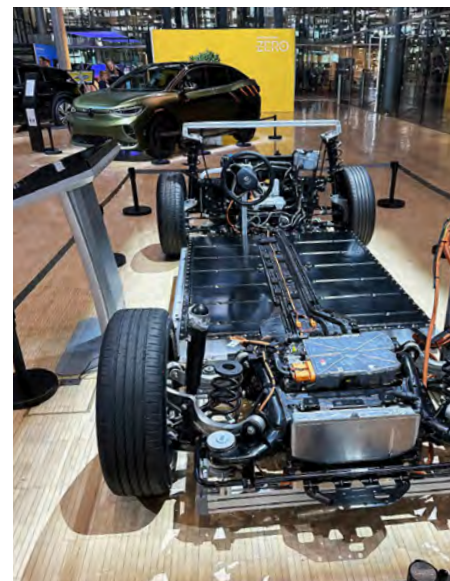
Der »Modulare E-Antriebs-Baukasten« (MEB) ist die einheitliche Fahrzeugplattform von VW, die speziell auf Elektroautos ausgelegt ist. Im Mittelpunkt ist die Batterie untergebracht. Fotos: FEGIME Deutschland
